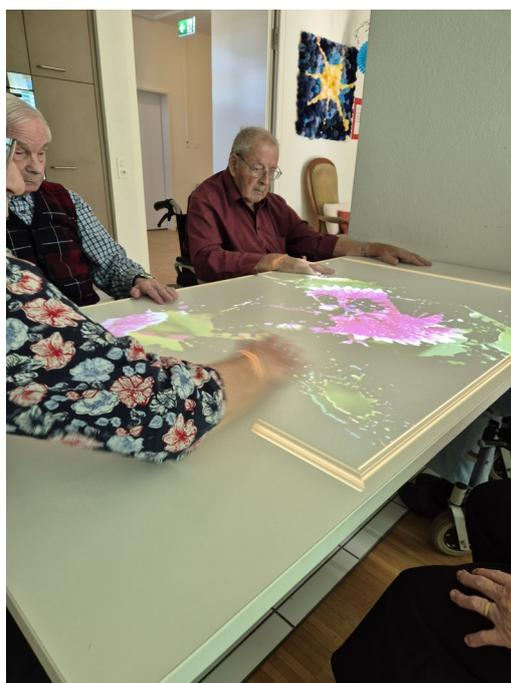
Das Tovertafel-System kombiniert einen Projektor, Infrarotsensoren und eine spezielle Software, um jede Oberfläche in einen interaktiven Spielbereich zu verwandeln.
